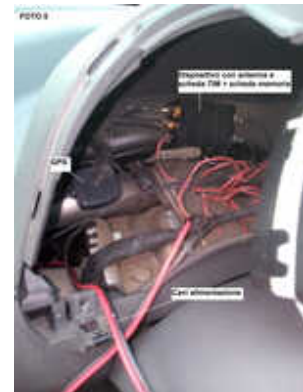
En sens antihoraire à partir d'en haut : dispositif avec antenne, SIM et carte mémoire; GPS; câbles d'alimentation
