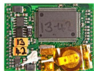
Module fournissant le signal GPS (autre côté)
