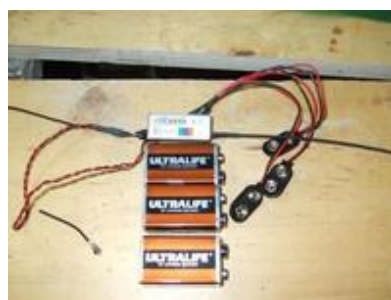
L'ensemble démonté. Les piles étaient déchargées.
