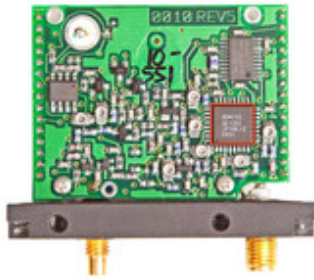
Module permettant la transmission par ondes radio
