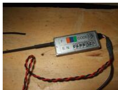
Détail de l'antenne émettrice avec son couvercle
