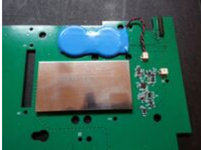
Version modifiée du plus grand circuit imprimé du téléphone (avec dispositif de surveillance). La batterie (en bleu) et le module isolé (en marron clair) font partie du dispositif de surveillance.
