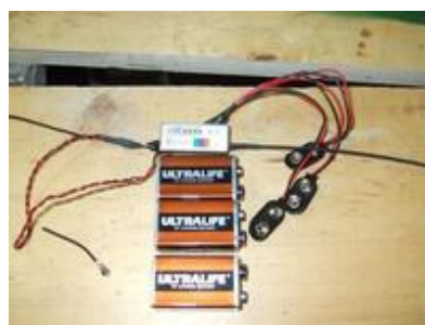
L'ensemble démonté. Les piles étaient déchargées.
