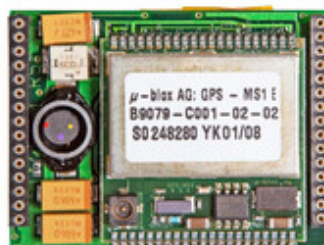
Module fournissant le signal GPS
