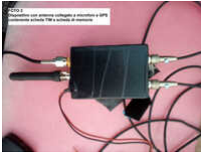
le dispositif avec antenne relié à micros et GPS. Il contenait aussi une SIM et une carte mémoire.
