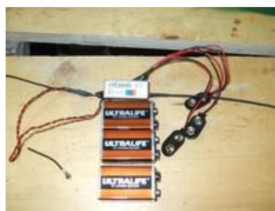
L'ensemble démonté. Les piles étaient déchargées.
