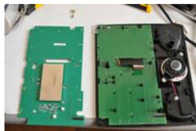
À gauche : version modifiée du plus grand circuit imprimé du téléphone (avec dispositif de surveillance) sans la batterie. À droite : version non modifiée.
