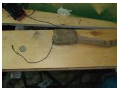
Voilà comment était le dispositif quand il a été retrouvé. A côté de la pièce de 2€ se trouve le micro, à l'opposé est attachée l'antenne.
