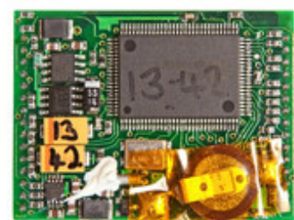
Module fournissant le signal GPS (autre côté)
