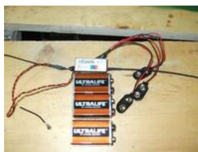
L'ensemble démonté. Les piles étaient déchargées.
