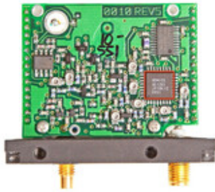
Module permettant la transmission par ondes radio
